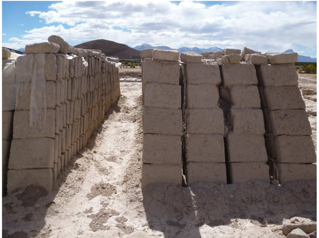
Figura 5. Fabricación de adobes en Cariquima, Colchane, Región de Tarapacá.
